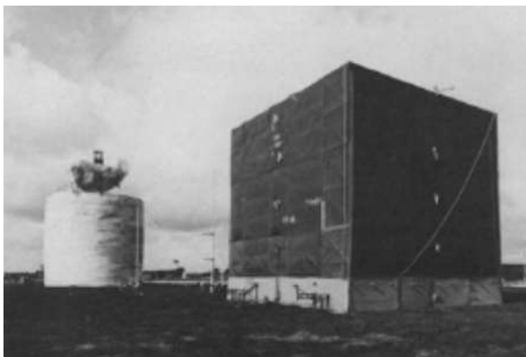
Рис. 2. Натурный эксперимент на острове Тони по исследованию распределения концентрации при обтекании строения после выброса газа из верхнего люка цилиндрического хранилища [1].
