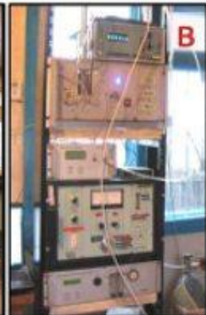
Автоматические газоанализаторы (ОПТЭК, С-Петербург, Россия) и счетчики частиц (DUSTTAK 8533», фирмы TSI Incorporated USA)
