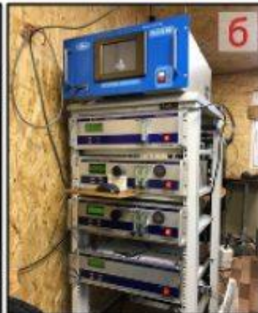
Автоматические газоанализаторы (ОПТЭК, С-Петербург, Россия) и счетчики частиц (DUSTTAK 8533», фирмы TSI Incorporated USA)
