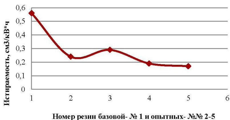
Рис. 2. Истираемость резин по металлическому диску
