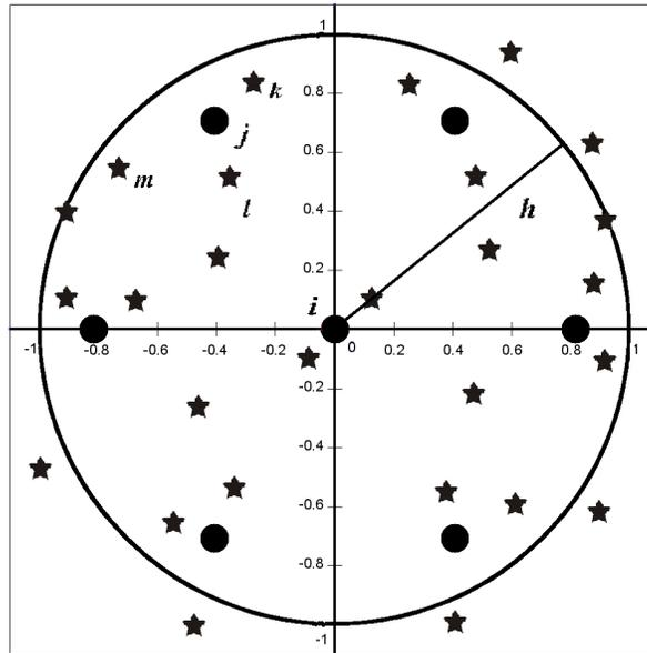
Рис. 4. Расположение ближайших точек SPH относительно квадратурных узлов для  $i$ -той точки в квадратуре с 7 квадратурными узлами, носитель  $h = 1$
