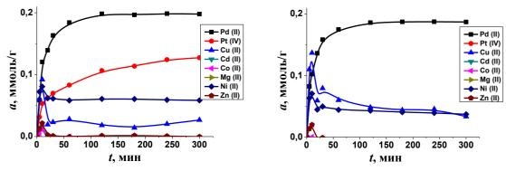
Рисунок 1 – Интегральные кинетические кривые сорбции ионов металлов СЭПАА
