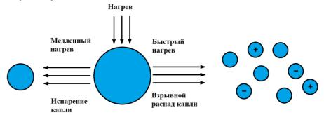
Рис. 1. Распад капли при нагревании.
