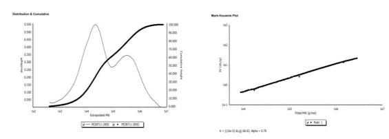
Кроме того, из рис.1 видно, что использование метода ГПХ дает возможность устанавливать мультимодальность исследуемых образцов, что особенно актуально в связи с увеличением производства и разработки новых типов полиэтилена (марок) с мультимодальным распределением.
