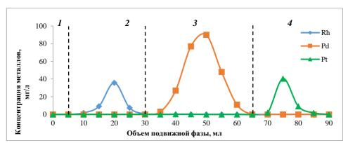
**Рис. 1.** Разделение Pt(IV), Pd(II) и Rh(III) в BCK. 1-50 мг/л Pt(IV), 50 мг/л Rh(III) и 250 мг/л Pd(II) в 1 M HCl (исходный раствор); 2-1 M HCl; 3-3 M HCl; 3-1 M Thio в 3-1 M HCl.
