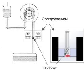
Рис. Схема магнитной установки для МТФЭ
