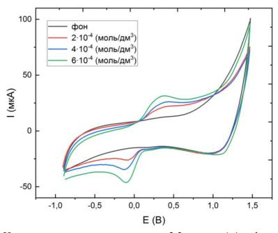
**Рисунок 1.** Циклические вольтамперограммы 2,3-дихлор-1,4-нафтохинона в спиртовом растворе 0,1 M NaClO<sub>4</sub> (pH 2,0) на ИМГЭ относительно ХСЭ (1 моль/л КСl); скорость сканирования потенциала 100 MB/c.
