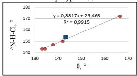
Рис.3 - Корреляция между транс-углом тетраэдрического полиэдра [CuCl<sub>4</sub>]<sup>2-</sup> и значением угла N-H-Cl: ■ — данные настоящей работы, ● — литературные данные
