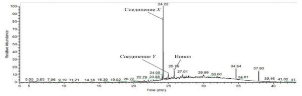
**Puc.1.** – Хроматограмма метанольного экстракта «состаренного» трансформаторного масла в режиме полного ионного тока (TIC).
