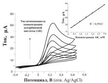
**Рис.1.** Циклические вольтамперограммы на  $MnO_2 / C$  - композитном электроде в фосфатном буфере с pH 7,4 с повышением концентрации аскорбиновой кислоты. Скорость сканирования 50 мB / с.
