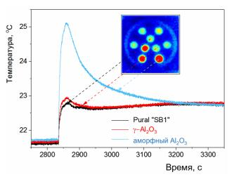
Рис.1. Тепловые эффекты при взаимодействии оксидов алюминия с водяным паром. На вставке — термограмма библиотеки из девяти образцов, измеренная в момент времени около 2950 с.
