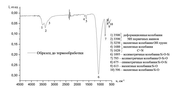
Рис. 1. Результаты ИК-спектроскопии в режиме МНПВО для образца без термообработки
