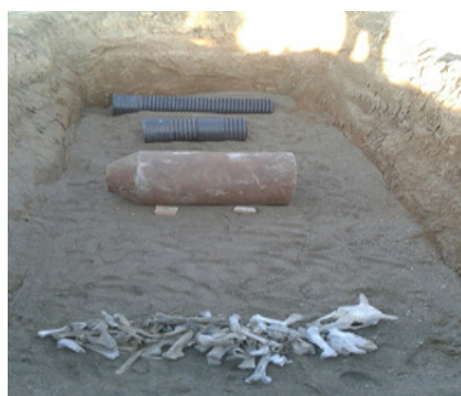
Рис. 10: Мишени, на днище котлована
