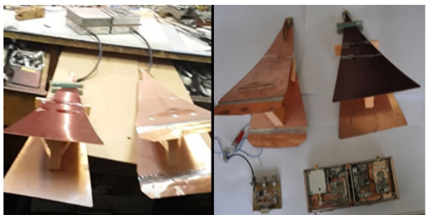
Рис. 3: Принимающая антенна и передающая антенна (фрагмент слева), Полная комплектация основных узлов прибора (фрагмент справа)
