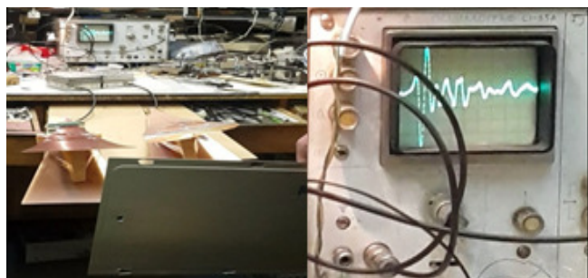
Рис. 4: Перед антеннами установлена металлическая отражающая поверхность (фрагмент рисунка — слева). Фрагмент справа — радарограмма
