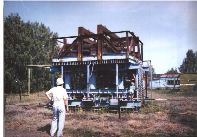
Значительная возмущающая сила, развиваемая источником (до 100 тс), длительные (до нескольких часов) сеансы излучения и прецизионные системы управления и регистрации обеспечивают наблюдаемый волновой эффект (сейсмограммы), сравнимый со средним землетрясением.
