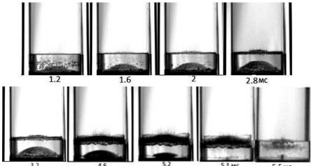
Рис. 1. Формирование и замыкание разрыва, образование кластера кавитационных пузырьков (точка в центре мембраны) - кадр 5.4 мс. Диаметр кюветы 12.5 см, высота водяного слоя 4 см, энергия нагружения 800 Дж.
