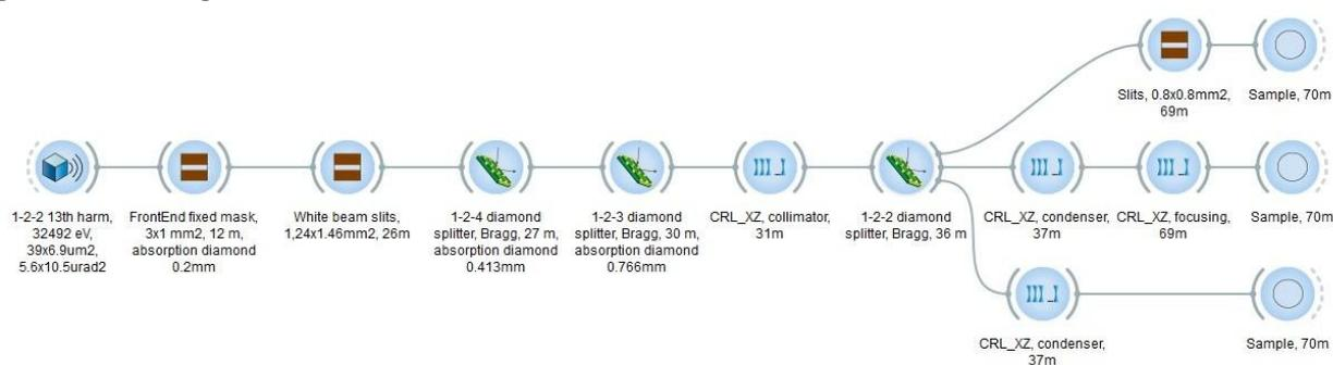
**Рисунок 5. Оптическая схема секции 1-2-2. Три различные ветви в правой части рисунка соответствуют трем возможным режимам работы секции**
