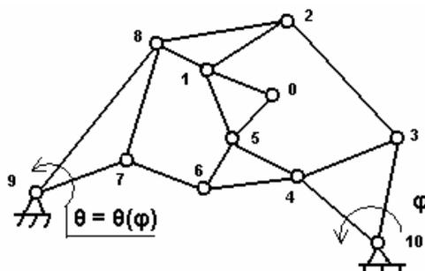
Рис. 1 Структурная схема рычажного механизма
