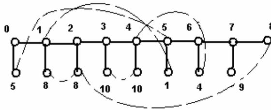
Рис. 2 Схема соединения диад в механизме
