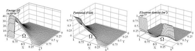
**Рис. 4.** Результаты расчётов с применением п.п.п. с параметрами  $V_D=1V, V_G=1V$ , B=-1,  $\delta=-0,001, l_v=20$  пт,  $N=40, K=40, \varepsilon_1=10^{-5}$
