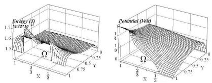
**Рис. 3.** Результаты расчётов с использованием вычислительной модели из [5,6] с параметрами  $V_D = 0.36 \, V, V_G = 0.36 \, V, B = 0, \, \delta = 0.8, \, l_v = 20 \, \text{nm}, N = 40, \, K = 30, \, \varepsilon_1 = 10^{-5}$
