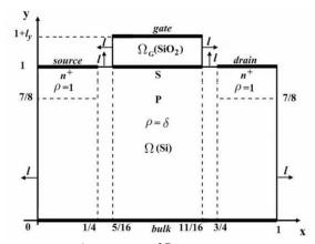
**Рис. 1.** Схематическое представление 2D кремниевого транзистора MOSFET
