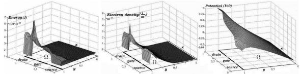
**Рис. 5.** Результаты расчётов с применением п.п.п. с параметрами  $V_D=1V$ ,  $V_G=1V$ , B=-25,328,  $\delta=-0,001, l_v=20$  пт, N=40, K=40,  $\mathcal{E}_1=10^{-5}$
