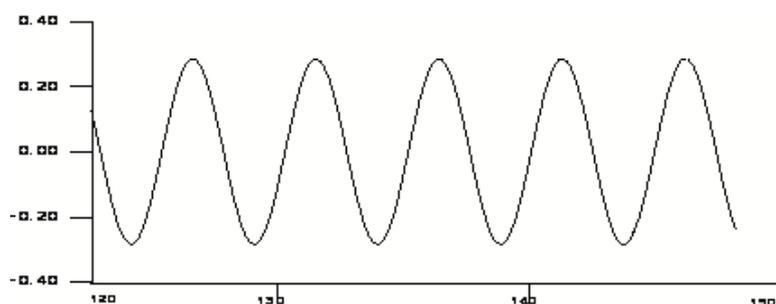
Рис. 3. Зависимость коэффициента подъемной силы от времени при обтекании одного препятствия.
