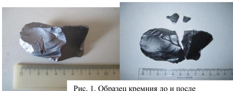
Рис. 1. Образец кремния до и после электрогидравлического дробления.
